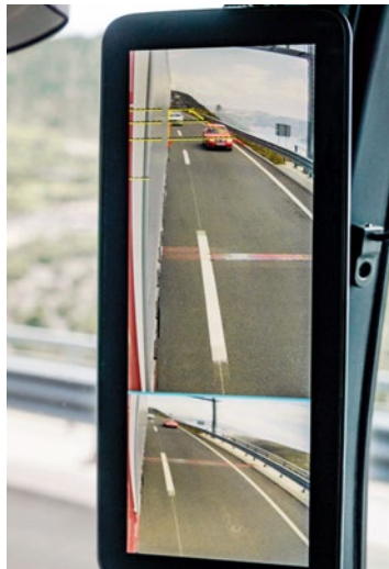
Oben: Die MirrorCam ist das Erkennungszeichen des neuen Actros. Unten links: Abstandslinien helfen beim Blick auf den rückwärtigen Verkehr. Unten rechts: Beim Abbiegen schwenkt die Kamera mit.
